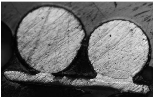
Fig. 5. Sezione lucida di due grani di pulviscolo, diametro circa 0,2 mm. Ricostruzione sperimentale di A. Pacini effettuata con
