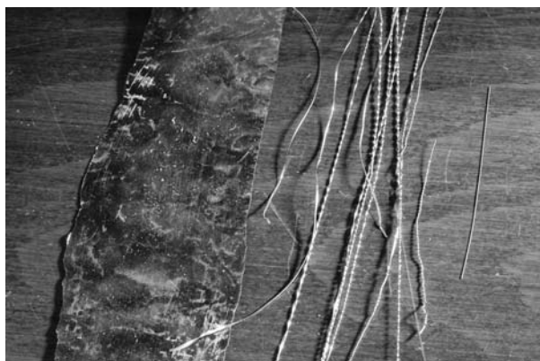
Fig. 2. Strisce d'oro ritagliate da una lamina di circa un decimo di mm di spessore
